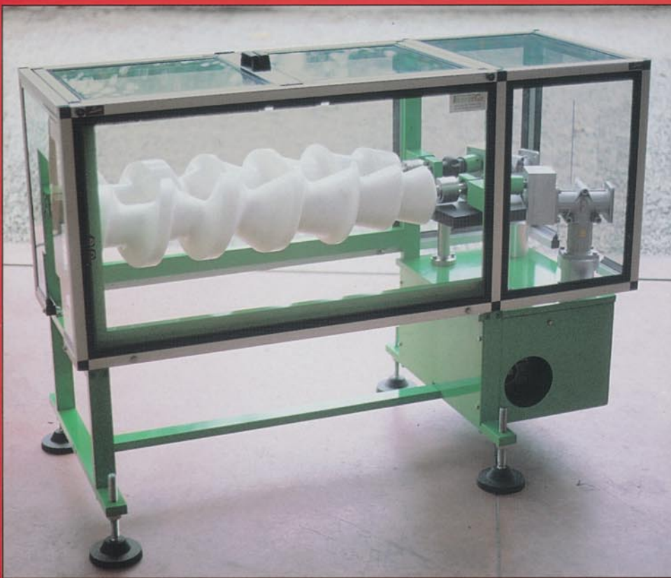
Gruppo rotatore per flaconi prismatici. Rotator for prismatic flacons. Groupe rotateur pour flacons prismatiques.
