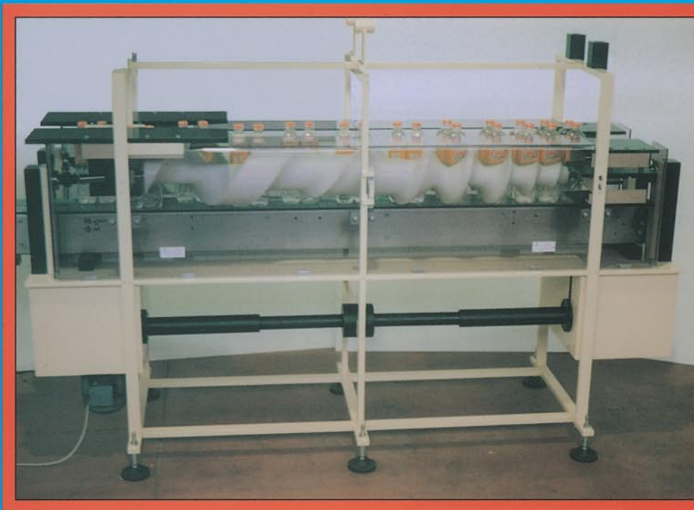
Gruppo rotatore-divider per fardelli. Rotator-divider unit for bundles. Groupe rotateur-diviseur pour fardeaux.
